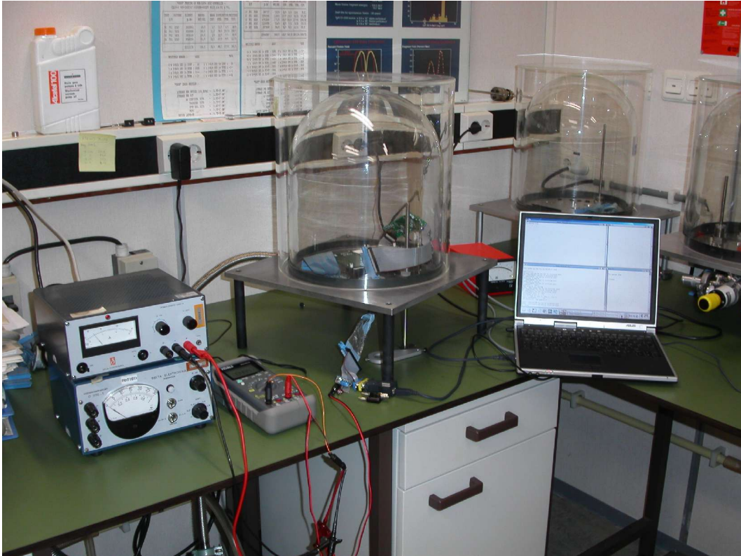
Figure 3- 1: ESTEC Californium SEU Test Set-up
